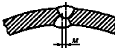
с — Несоответствие оси M валиков швов (ДСФ трубы)
