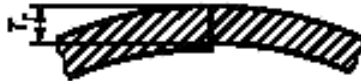
T_r — остаточная толщина из-за радиального смещения кромок а — Радиальное смещение кромок рулонного проката (ТВЧС трубы)
