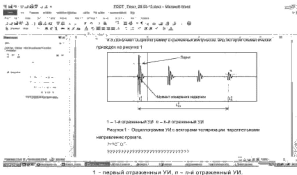
Рисунок 1 – Осциллограмма УИ с векторами поляризации, параллельными направлению прокатки
