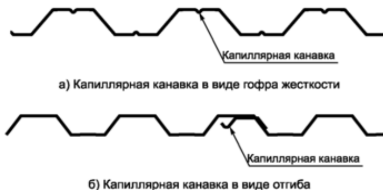
Рисунок 3 — Основные виды капиллярных канавок
